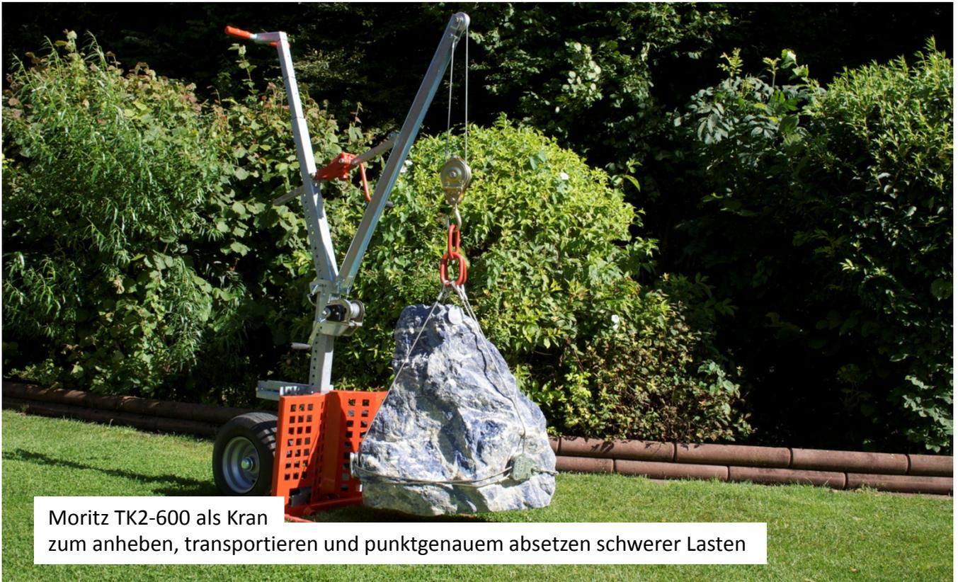
Moritz TK2-600 als Kran zum anheben, transportieren und punktgenauem absetzen schwerer Lasten
