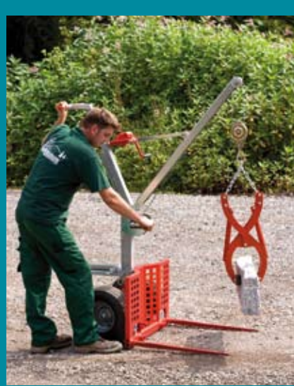
Kran und Steinzange
